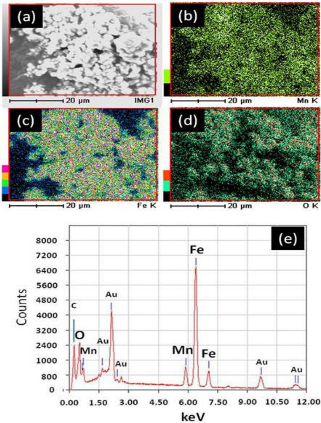
**Fig. 5.** EDX images of  $\text{Mn}_3\text{O}_4\text{-Fe}_2\text{O}_3$  composite phases, (a) image, (b) Mn, (c) Fe, (d) O, and (e) EDX spectrum.
